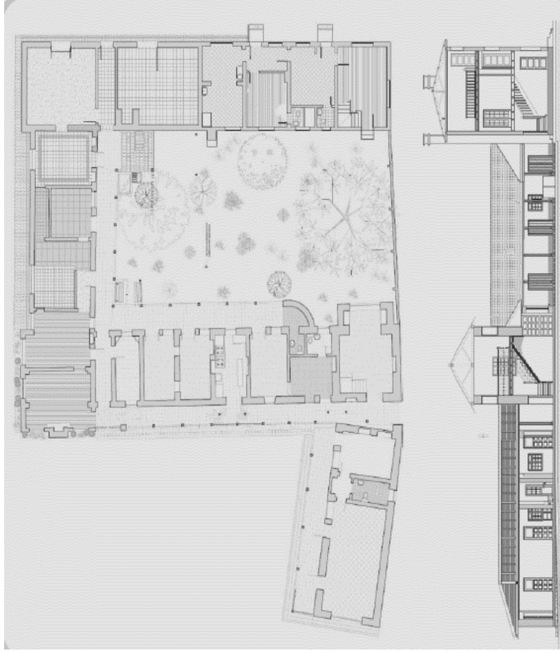
Levantamiento para proyecto de intervención. Planta y corte de la casa principal.
